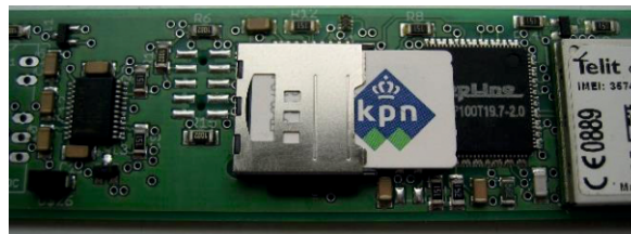
SIM карта, установленная на PCB, карта памяти микро SD на 2 ГБ установленная под держателем SIM карты
