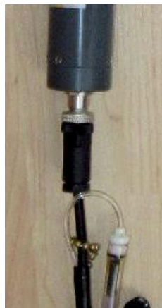
Разъем INW (IP67) установленный трубчатом корпусе
