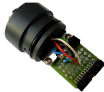
Нижняя часть с платой подключений (Подключена плоским кабелем к основной плате)
