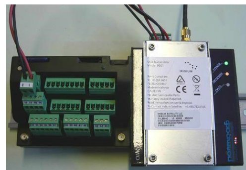
Регистратор с опциональным спутниковым модемом
