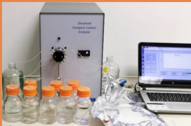
Рис. 1. Анализатор AS-C5 с многопортовым пробоотборником и детектором CO 2 LI-850, вид спереди (внутри основного анализатора)
