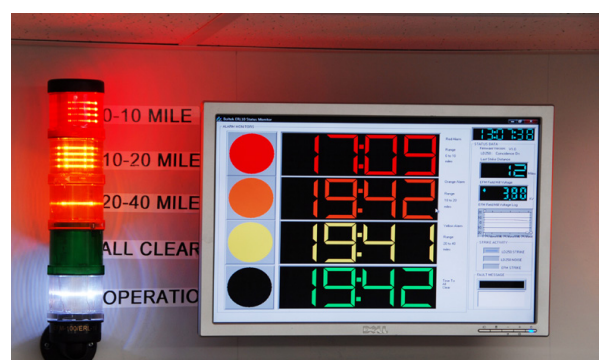
Stacklight подключен к ERL-10 (stacklight не входит в комплект)
