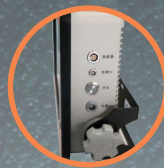
Вход DGNS / RTK
